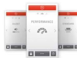
Modo de funcionamiento intuitivo y selección de menú en varios idiomas a través de la pantalla táctil de alta resolución de 4,3". La información relevante como los modos de funcionamiento e informes de estado, material de consumo, máquinas y datos de contacto se pueden visualizar.
